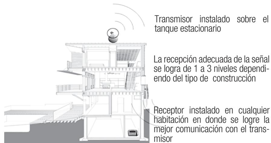
**Figura 2. Módulo Receptor**
